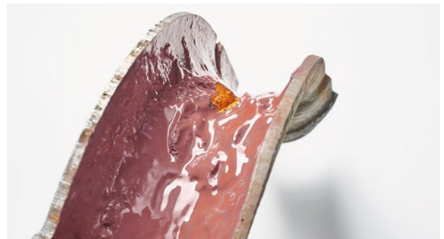
Abb. 4: Mangelhafte Reinigung und Haftung auf der Innenseite des Rohrbogens (Quelle: SVGW)
