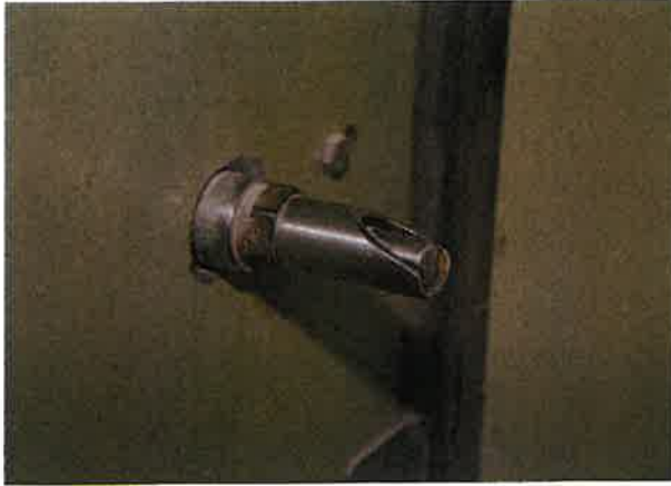
Abb. 10 Beissnippel mit beweglichem Stift
